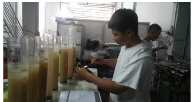
Hình 4. Thí nghiệm thành phần hạt
