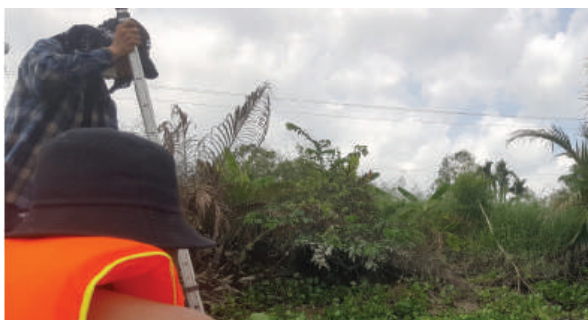
Hình 5. Đo mặt cắt ngang sông bằng mia
